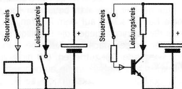
Der Transistor tut dies auch, mit zwei ganz gravierenden Vorteilen: er ist *viel* schneller (Nanosekunden im Vergleich zu Millisekunden!), und er arbeitet *kontaktlos*, also **verschleiss- und funkenfrei**, mithin der ideale Ersatz für den Unterbrecher!
